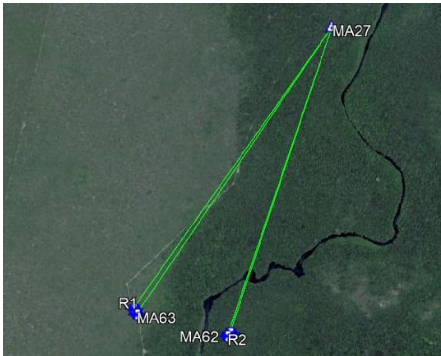
Figura 5-7: Esquema empregado na implantação dos marcos das seções topobatimétricas
